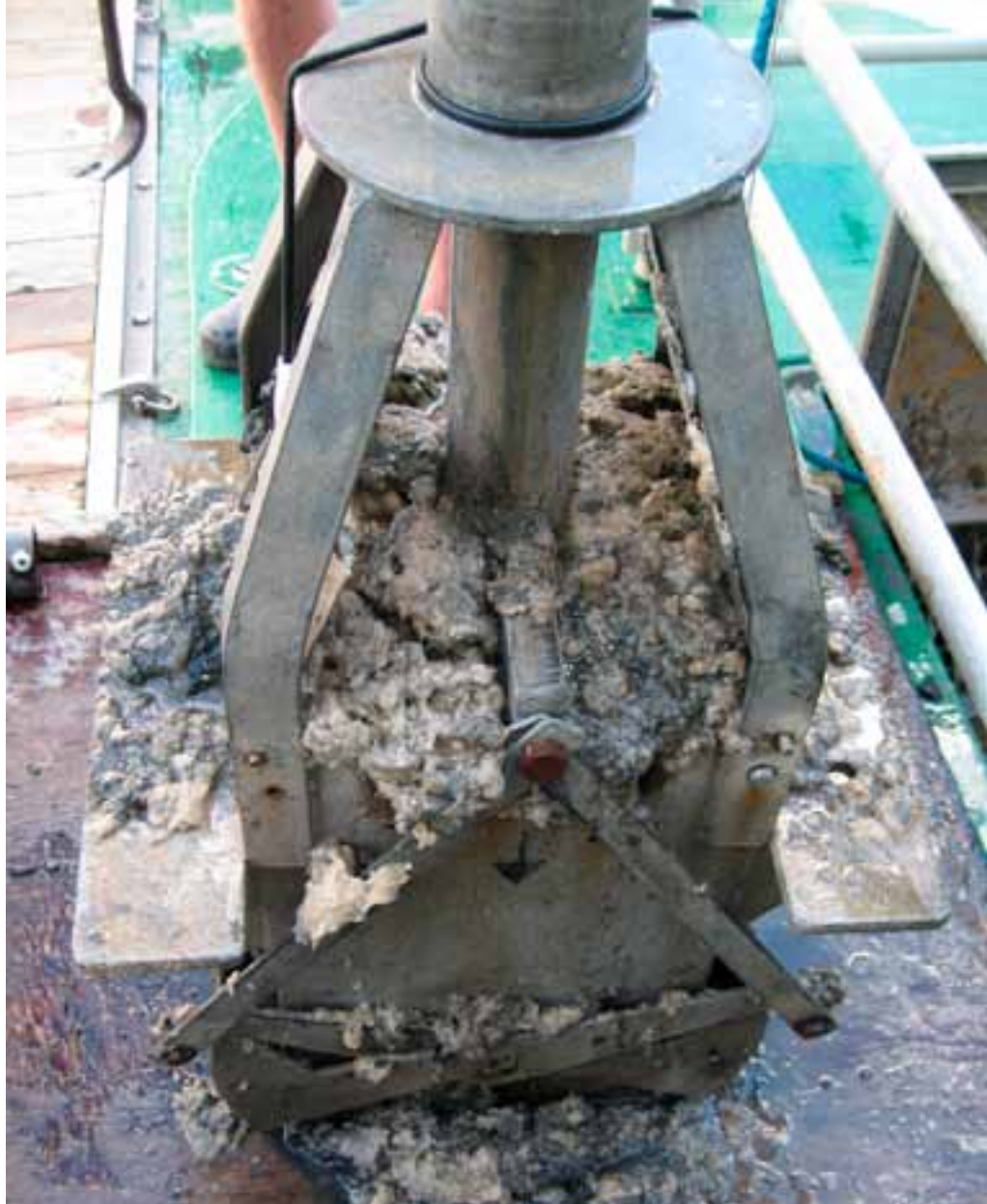
Cellulosafibrer i en provtagare: Materialet i fiberbankarna består på många platser uteslutande av cellulosa från gamla utsläpp. Cellulosan innehåller höga halter miljögifter, som kan frigöras till vattenmassan då materialet eroderas eller lossnar vid undervattenskred.
